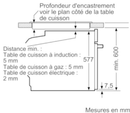
Si l'appareil est installé sous une table de cuisson, les épaisseurs de plaque de travail suivantes (le cas échéant y compris la sous-structure) doivent être respectées.
